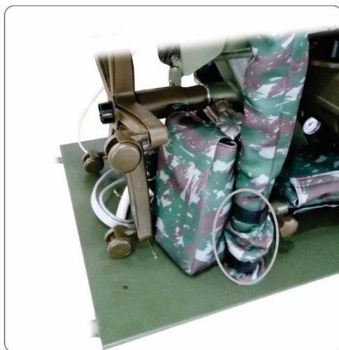
20 - Fije con Velcro® el embalaje de los tanques de agua en el brazo de la lámpara.
